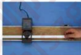
图 11.4-3 用打点计时器测量手拉纸带的速度
